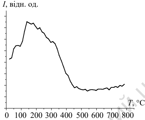
Рис. 3.32. ТД профіль води для зразка № 7 із вмістом Fe = 1,25 мас. %, Co = 90,25 мас. %, Cu = 4,75 мас. %
