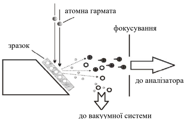
Рис. 4.5. Утворення іонів шляхом бомбардування зразка швидкими атомами/іонами
